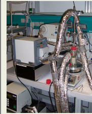
Kristallisationsversuchsstand mit Online-Analytik (60 mL-Reaktor; 1,8 mL/min; Polarimeter POLARmonitor, IBZ Messtechnik; Dichtemessgerät DE40, Mettler-Toledo)
