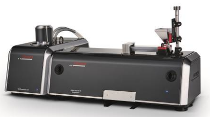
NEU: Partikelmessgerät ANALYSETTE 28 ImageSizer Messbereich: 20 µm – 20 mm
