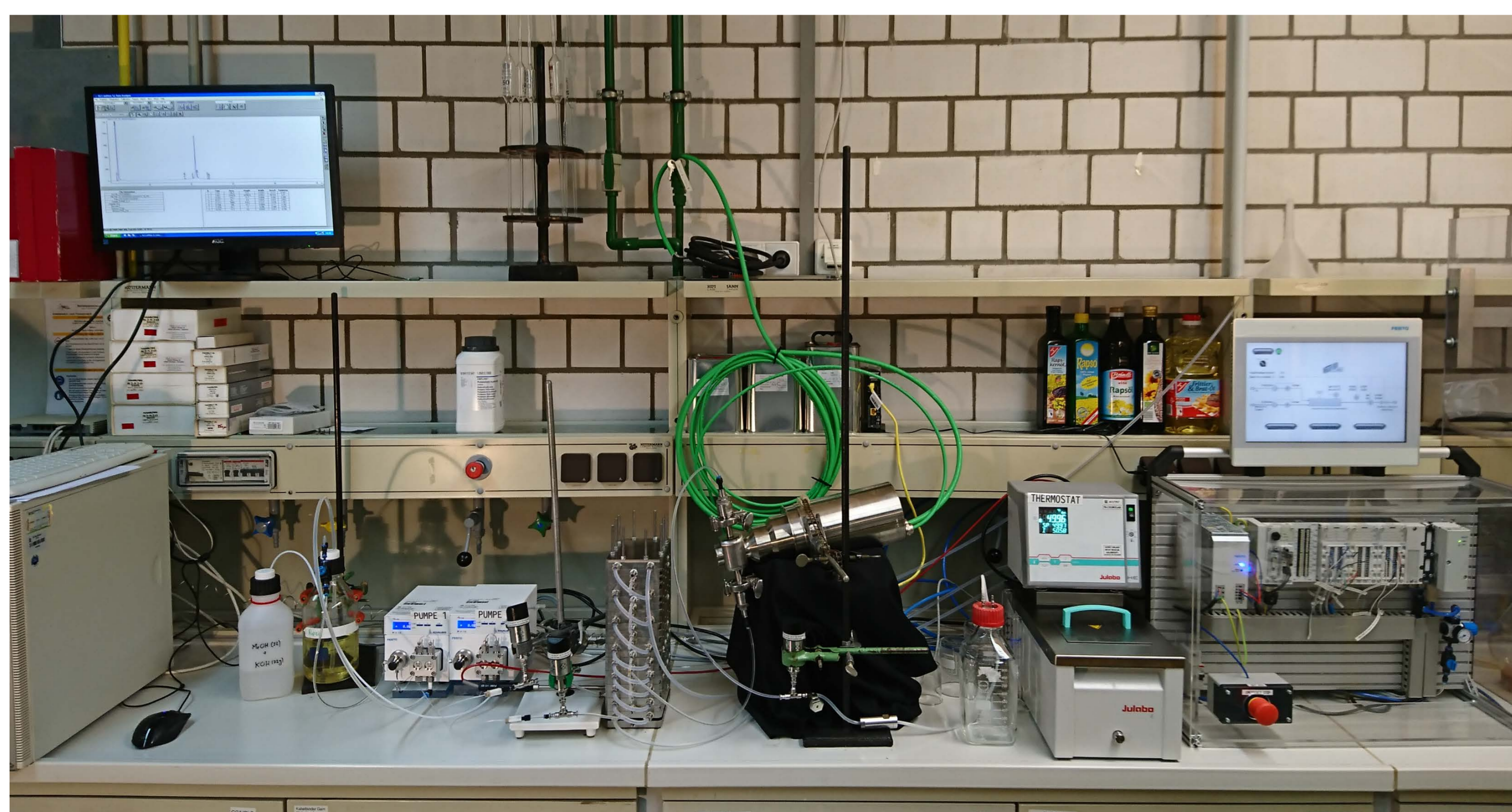
Laboranlage zur Biodieselproduktion
