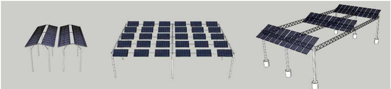
Bild 43: Illustration verschiedener Anlagentypen mit Ost-West-, Süd- und Süd-Ost-Ausrichtung. © Fraunhofer ISE
