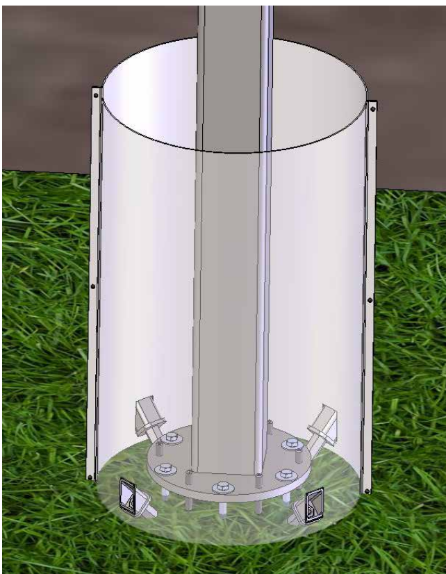
Bild 20: Rammschutz der Aufständigung der Anlage in Heggelbach vor der Beschädigung durch Landmaschinen. © Hilber Solar
