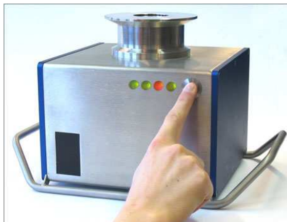
Abb.2: BlendAlyser mit Status-LED
