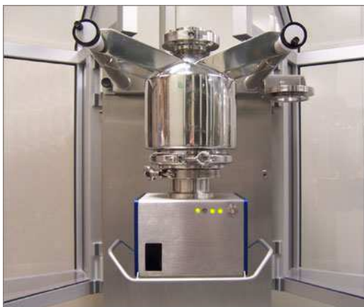
Abb.1: BlendAlyser am Mischer installiert
