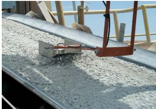
Sensor Litronic-FMS II im Gleitschuhschlitten eingebaut am Förderband.
