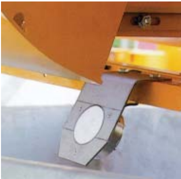
Sensor Litronic-FMS II direkt unter dem Siloauslass angebaut.
