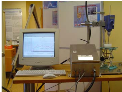
Aufbau im MTS-Versuchslabor: ParticleScan mit Sensor, Elektronik, Auswerte-PC und Rührer
