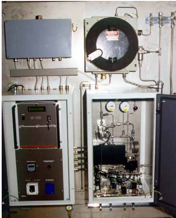
Bild : Rhadox zur Bestimmung der kalorischen Werte von Fackelgas in einem Chemiebetrieb
