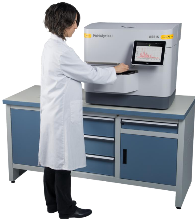
Bildunterschrift: AERIS – das neue Benchtop-Röntgenpulverdiffraktometer von PANalytical
