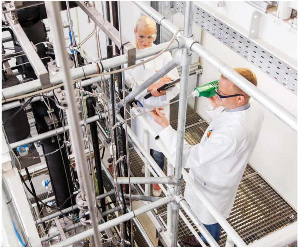
Schnelle Installation der SOPAT-VR zur Bestimmung der Tropfengröße von Dodecen in H_2O an einer Miniplant. ➤
