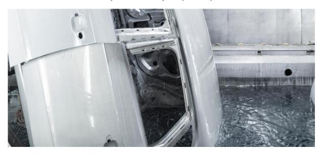
Die Elektrotauchlackierung (ETL) zählt zu den effektivsten Lackierverfahren mit bestmöglicher Beschichtung komplexer Bauteile. Dennoch spüren Anlagenhersteller und –betreiber immer mehr den Druck den Gesamtprozess noch wirtschaftlicher zu gestalten und gleichzeitig ressourcensparend und umweltfreundlich zu handeln. Ein Qualitätskriterium stellt in diesem Zusammenhang auch die Rückverfolgbarkeit von Produktionsprozessen dar.
