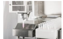
Greifer injiziert SMART Säule in ThermELUTE-Modul.
